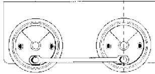
Bei der Montage, Kuppelstange auf Radzapfen schrauben, ist unbedingt sicherzustellen, daß die Kuppelstange bei keiner Radstellung klemmt. Dieses führt sonst unweigerlich zu schlechten Fahreigenschaften und u.U. zur Zerstörung des Getriebes.
