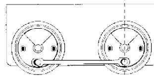
Lors du montage, visser la bielle d'accouplement sur les tourillons de roue, s'assurer que la bielle d'accouplement ne grippe dans aucune des positions de la roue afin d'éviter toute mauvaise qualité de roulement et, le cas échéant, toute détérioration de l'engrenage.
